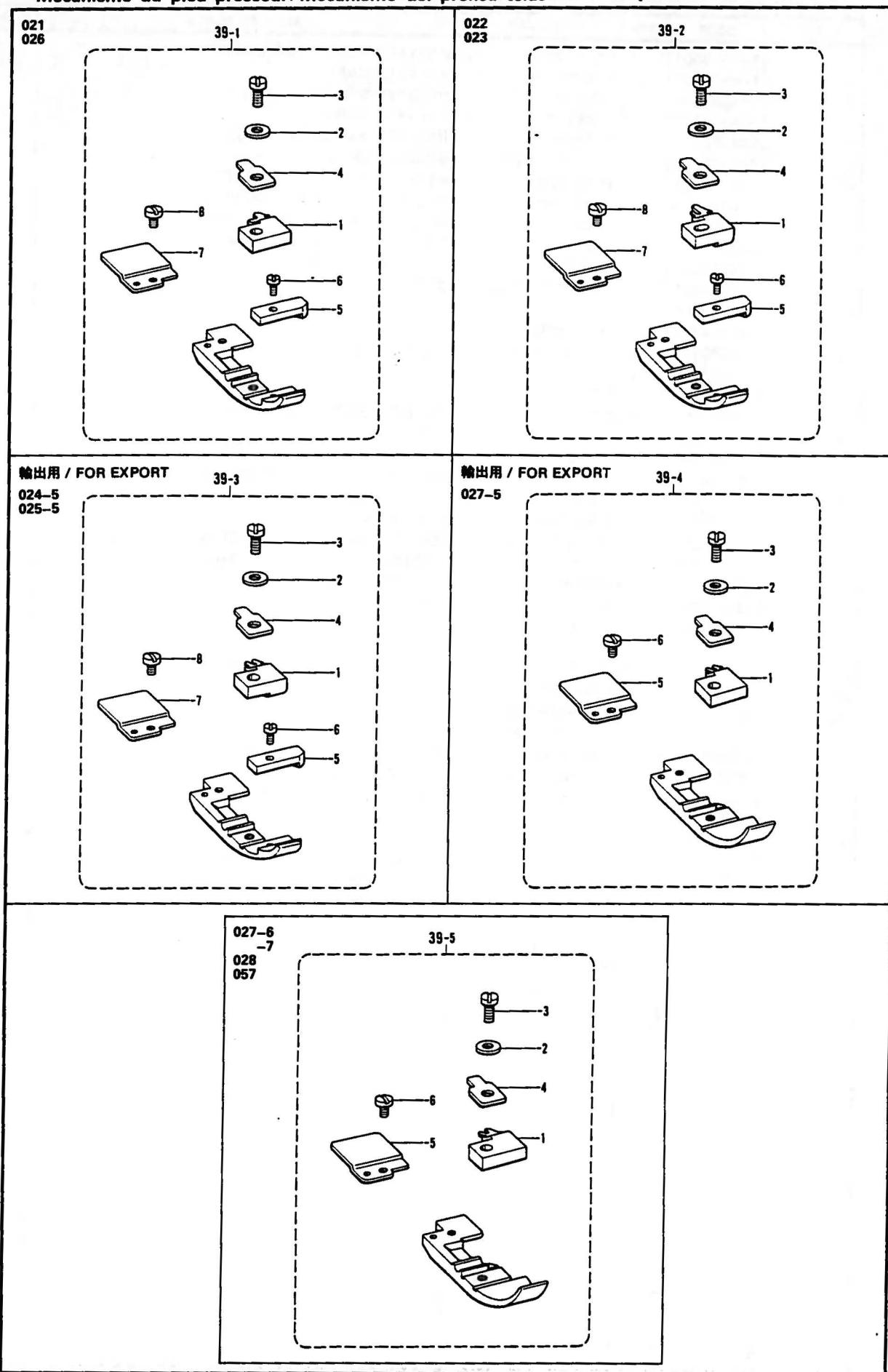
E. 押工関係/Presser foot mechanism/Stoffdrückerfuß/
